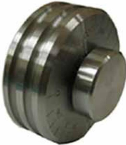
ロータリ形ウェットフィルム膜厚計と呼ばれるもので、簡単にウェット膜厚を測定する機器です。
