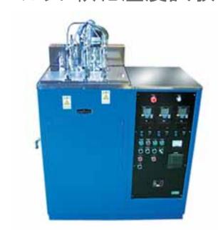
プラスチック材料のビカット軟化温度(VST)を測定する装置です。
