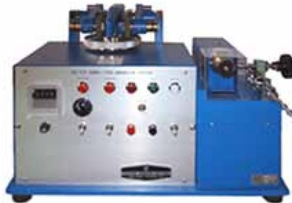
金属・プラスチック・塗膜・ゴム・合板・繊維製品等のあらゆる材質の摩耗度を測定する装置です。回転台に試験片を取り付け状態で摩耗輪を回転させ、試験片を摩耗します。ダイヤモンドドレッサーによって摩耗輪の目詰まりを除去し、除塵装置により摩耗粉を吸引しながら行われますので、再現性の高い試験結果を得られます。試験前後の質量差から、摩耗質量を測定します。
