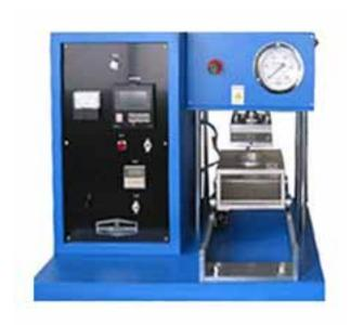
ラミネートフィルムの容器熱溶着を評価する試験機です。ヒートシールテスターと同様 に温度、圧力、時間を各々可変管理できます。
