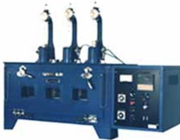
絶縁用ビニール、プラスチックシート、電線等の材料を一定荷重、一定温度の状態で経時変形率を測定する装置で、試料本数は各々用意出来ます。
