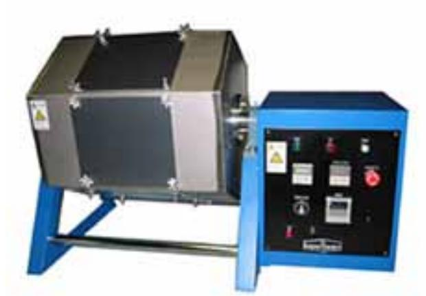
フローアポリッシュを塗付した床材における、黒色ゴムの耐付着性(ヒールマーク性)を測定する装置です。
