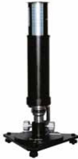
紙及び板紙、繊維製品等の透気度を測定する装置です。オプションのデジタルオートカウンターと組み合わせることで、高精度な測定が可能です。
