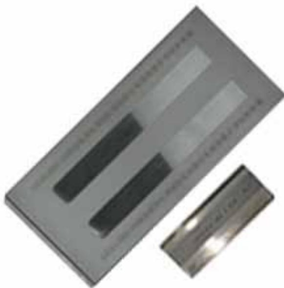
塗料、顔料、印刷インク等の組織粒の大きさを測定するゲージです。表面には傾斜溝が形成されていて、一定量の試料を溝の深い側から浅い側へ、付属のスクレーパーで掻き取って塗膜を形成し、粒の密度の変化を観察して溝深さの目盛を読み取ります。
