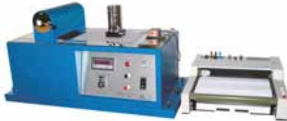
フィルム・紙・金属板・床材等の摩擦係数(静摩擦係数・動摩擦係数)を測定する装置です。波形処理により評価しますので、開発から品質管理部門まで幅広く活躍します。
