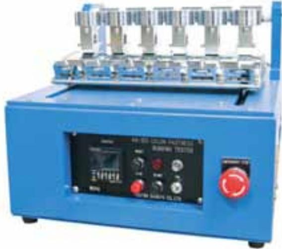
染色布の色移りや、金属、樹脂板の塗装面、フィルム・アルミ箔・紙等の印刷面の耐摩擦性を測定する装置です。摩擦子や荷重変更等で様々なニーズに対応します。
