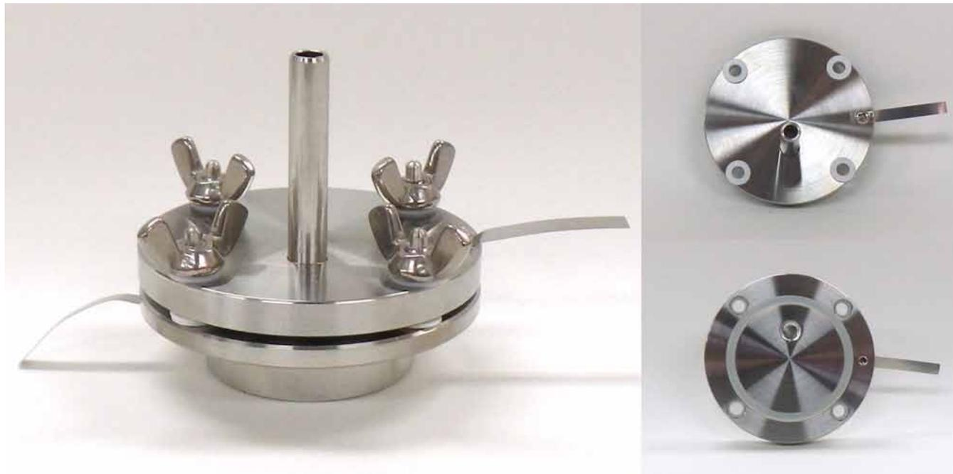
電池評価用二極セル(2E-CELL-SUS)にガス抜きパイプを取り付けたものです。過充電や過放電時に発生するガスの量を圧力から推算し、その成分を分析するために抜き取りパイプをつけています。電池の基礎研究・開発からサイクル試験・特性試験まで幅広い測定に対応する実験用セルです。組立、分解が容易でコインセルによる実験のわずらわしさから解放されます。電池試料はスプリングにより適正に圧力が掛けられ耐薬品性に優れたテフロンシールで密閉されて電解液の漏出の恐れを解消しました。グローブボックス内での組立後は外気に接触しても電池試料には影響しません。
