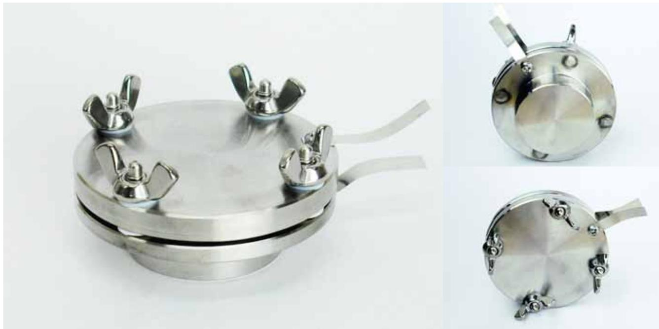
充放電試験装置に接続して電池の基礎研究・開発からサイクル試験・特性試験まで幅広い測定に対応する実験用セルです。組立、分解が容易でコインセルによる実験のわずらわしさから解放されます。ネジ込み(スウェージロック)式と異なり電極表面にダメージを与えることなく容易に組立てられます。電池試料はスプリングにより適正に圧力が掛けられ耐薬品性に優れたテフロンシールで密閉されて電解液の漏出の恐れを解消しました。グローブボックス内での組立後は外気に接触しても電池試料には影響しません。
