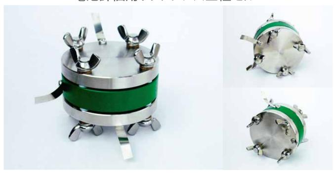
電池評価用二極セル(2E-CELL-SUS)と同様コンパクトな設計で、電池の基礎研究・開発からサイクル試験・特性試験まで幅広い測定に対応する実験用セルです。 組立、分解が容易でコインセルによる実験のわずらわしさから解放されます。 電池試料はスプリングにより適正に圧力が掛けられ耐薬品性に優れたテフロンシールで密閉されて電解液の漏出の恐れを解消しました。グローブボックス内での組立後は外気に接触しても電池試料には影響しません。 中央部のリファレンス電極で基準値を設けることで単極の電位をモニタリングすることができ、より詳細な測定データが入手可能になりました。
