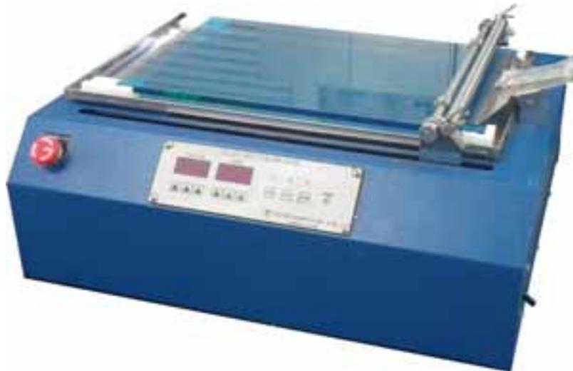
各種アプリーケーターを使用してインキ、塗料、粘着剤、電池用電極触媒ペースト、エマルジョン系樹脂等を紙、フィルム、金属箔等に機械的に塗工する装置です。一定荷重・一定速度下において塗工することで、塗工ムラや個人差を解消し、所定の膜厚で塗膜することが可能になりました。ベーカー式アプリーケーター、ドクターブレード、バーコーター、マイクロメーター付フィルムアプリーケーターを簡単に装着して使用できます。同一条件で、誰でも均一な皮膜が作れます。塗工台は研磨ガラス板を採用、掃除も容易です。
