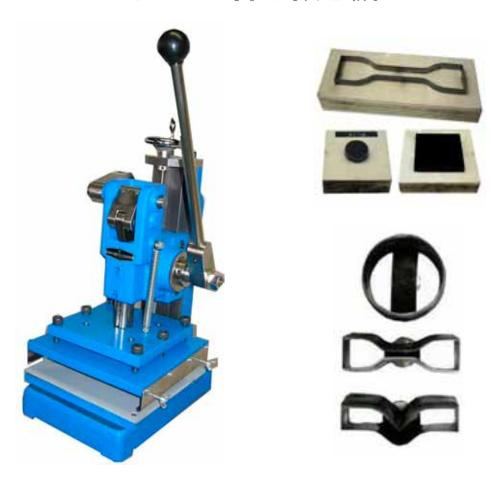
金属箔等のあらゆる軟質シートをワンタッチで手軽に打抜ける便利な打抜き器です。打抜刃は指定により各種製作します。
