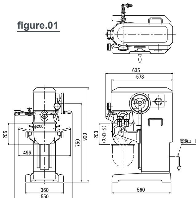
低粘度から高粘度物質の混合・攪拌そして特に混練に優れたミキサーで、遊星運動をするブレードが高度なミキシング効果を生み出します。
