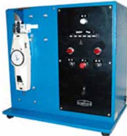
アルミとフィルムのラミネート材の引裂強度を使用する条件にあわせて測定する為に設計製作された装置です。
