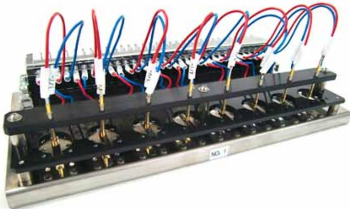
充放電試験機などの測定機にセルを接続する為の治具です。4端子法測定を行う測定機に対応します。
