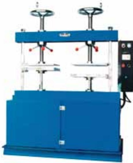
ウレタン・クッションラバー等に一定の繰返し圧縮変位を与えて疲労させ、厚さの変化を評価します。
