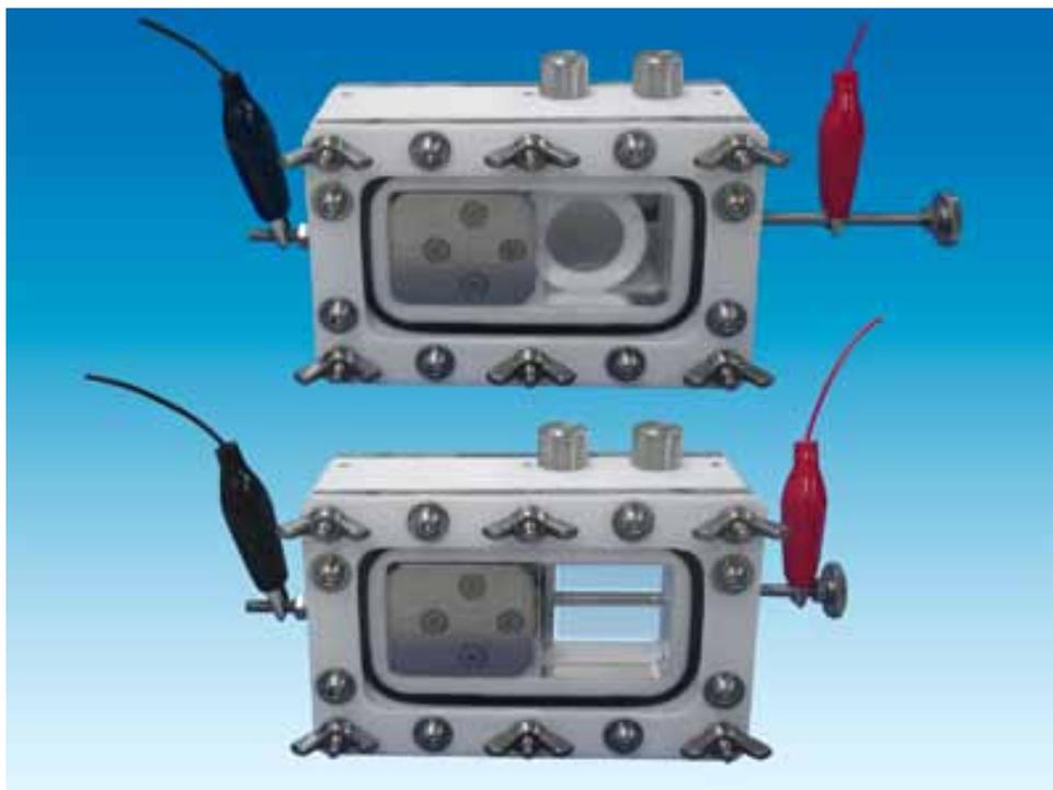
充放電試験装置に接続して電池の基礎研究・開発からサイクル試験・特性試験まで幅広い測定に対応する実験用セルです。組立、分解が容易でコインセルによる実験のわずらわしさから解放されます。従来使用されてきたネジ込み（スウェージロック）式と異なり電極表面にダメージを与えることなく容易に組立てられます。耐薬品性に優れたテフロンボディで密閉されて電解液の漏出の恐れを解消しました。グローブボックス内での組立後は外気に接触しても電池試料には影響しません。のぞき窓に石英ガラスを採用することにより、電極ホルダーをスライドさせて電池内部で起こりうる現象を分解することなく観察できるようになりました。電池の短絡を引き起す原因ともなるリチウムデンドライトの発生過程などのモニタリングに寄与します。
