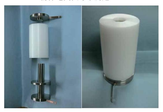
活物質と導電助材を混合した粉体の電気伝導率を測定するためのセルです。 Specification:
