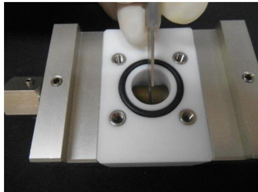
セル内部の電極間の距離をスペーサー等により設定、距離を一定に保ち、セル内部を密閉にすることにより、液体及びゲルの電気伝導度の測定を行うためのセルです。
