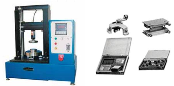
板紙を所定のリングにして、その軸方向へ荷重を加えた時の圧縮強さを評価する圧縮試験機です。オプションでアタッチメントを交換し、段ボールの接着力試験や平面圧縮試験及び垂直圧縮試験も行えます。
