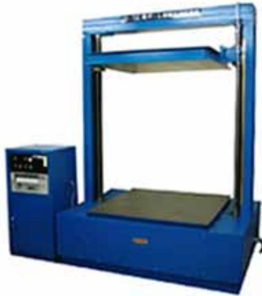
段ボール箱等の商品パッケージの耐圧試験を目的とした装置で、対面、対稜、対角全ての圧縮強度を測定出来ます。又、荷重値は記録計に記録します。
