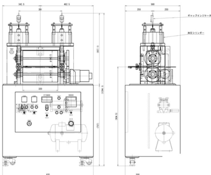
加圧荷重が調整可能なロールプレスで、オプションで、上下ロールのギャップ調整と加熱機構を追加できます。電極材料の密度調整などが可能です。作業中の圧力をデジタル表示できるので詳細データの管理が簡単に行えます。
