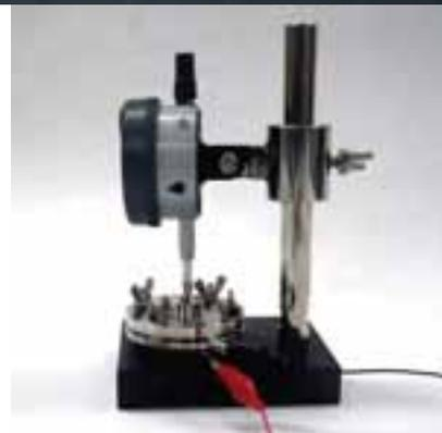
電極を入れるセル部は電極膨張率測定セル(本体)2E-CELL-ETCを架台に固定しその上に変位測定器としてデジタルゲージを固定する取付支柱を有している構造になっています。測定セルの充放電前にデジタルゲージ測定端子をセル中央部に接触させ固定します。それにより充放電時の電極の厚み変位や最大膨張率が測定できます。(専用スタンド及びデジタルゲージは別売りです)
