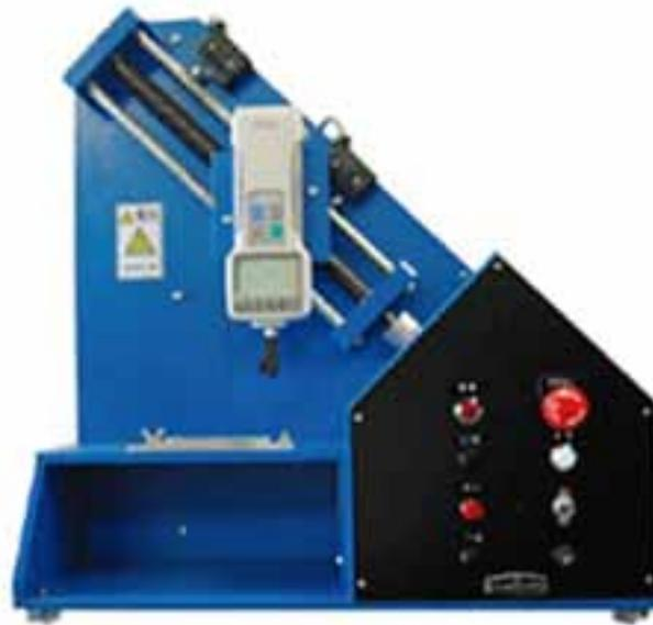
各種粘着テープ類、保護シート、金属箔等の90° 剥離強度測定専用装置です。剥離治具では信頼性が低く、また、ロスを考慮しなければなりませんでした。当機は独自機構により忠実に90° 剥離を実現します。
